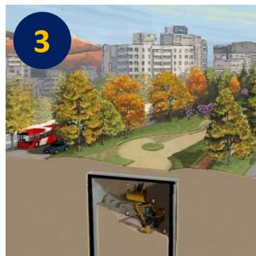
Conformada la estructura de los túneles e instalada la losa del techo, **se cubrirá la parte superior, se repondrá el parque** (trasplantando las especies que se encontraban en viveros) **y se continuarán las obras desde el interior**.
