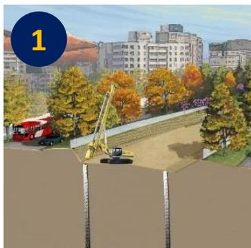
El túnel en la modalidad trinchera cubierta **está constituido por dos paredes laterales**, que se ejecutan mediante pilotes, excavados consecutivamente hasta la profundidad requerida. Previo a ello, **se salvaguardarán las especies arbóreas del parque**, las que se trasplantarán *in situ* o a viveros.
