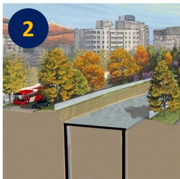
Se trata del **método constructivo menos invasivo**, que permite que, mientras se trabaja en el bandejón central abriendo la trinchera e instalando los pilotes, puedan **seguir circulando los vehículos por las vías laterales**.
